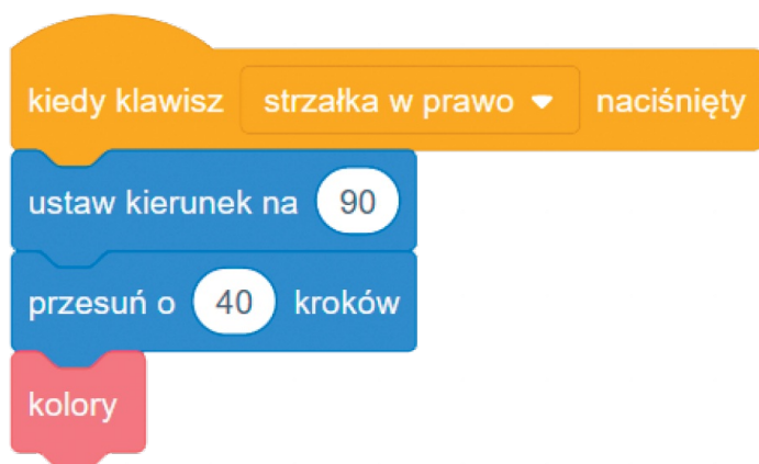
Rys. 7. Skrypt przesuwania duszka w prawo ze sprawdzaniem koloru następnego kwadratu
